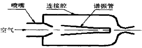
图1 气动谐振加热试验件结构图
